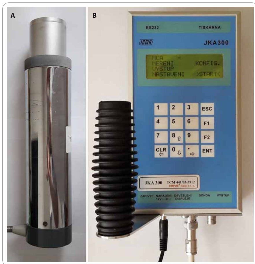
Obr. 2. Scintilační sonda NaI(Tl) (A) a amplitudový analyzátor JKA 300 (B).
