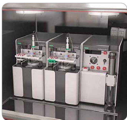
Obr. 3. Sestava modulů Synthera V2 a Synthera HPLC s osazenými integrovanými fluidními procesory (IFP). Zdroj [37].
